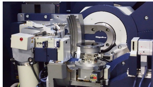
X線回折装置；亜酸化銅発熱・発火現象を証明するため、現場から採取した電気接続部の亜酸化銅生成の有無を分析
